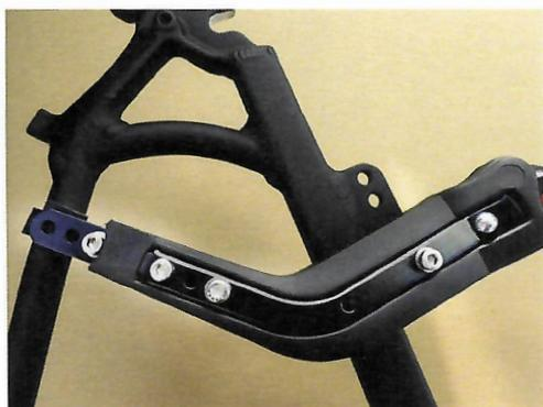
Ungeeignete Seitenständer können bei zu großer Krafteinwirkung die Kettenstrebe beschädigen.
